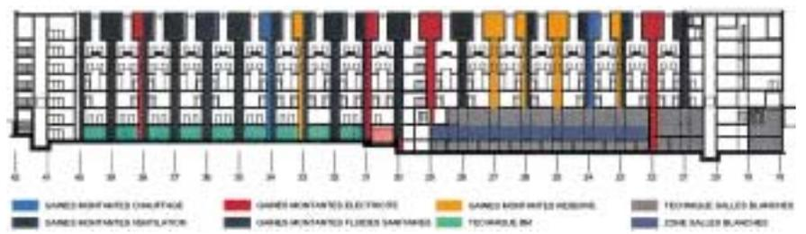
BM - coupe longitudinale - principe CVSE
