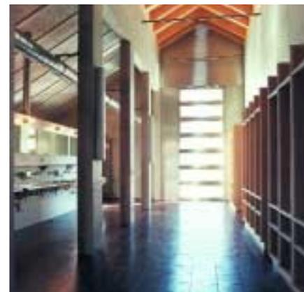
Simple et logique dans sa conception, l'édifice l'est également dans ses dispositions constructives : fondé sur un socle en béton armé qui comprend la dalle sur rez et se prolonge en élévation dans la partie arrière, le bâtiment est entièrement construit en bois dans sa partie sud, dès le niveau du premier étage.
